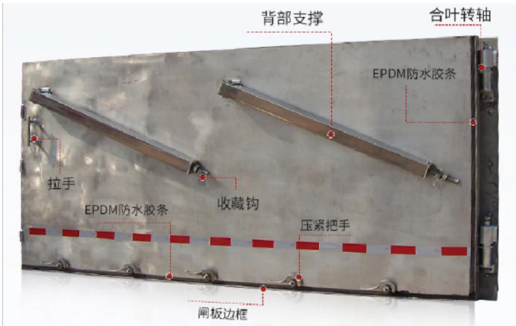
铝合金防洪挡水板是怎么制作的?这种防洪挡水板制作过程很简单，都是模具冲压出来，所以不管成外观还是表面处理都比较光滑，表面也经过腐蚀特殊处理。2. 安装出入口防洪挡水板地面有什么要求吗？只要不是坑坑洼洼的地面，一般没有什么要求的，钢板底部有防水胶条，地面不需要多平整，如果地面坑坑洼洼，那么安装挡水门就复杂一点，要地面预埋小钢板是地面平整，这样安装挡水门就滴水不漏了。铝合金是钢材中比较好的材料，使用的地方也比较特殊，一般是地铁站海口码头港口出入口沿海地方等等，因为靠近海边的地方都是淡水，含盐量比较高，腐蚀性也比较强，然而铝合金抗腐蚀性强常年不生锈，是较适合这些地方安装的。
